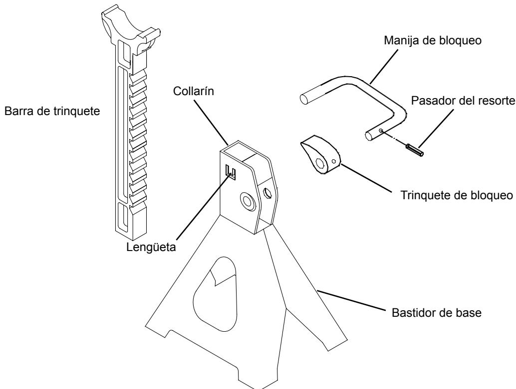
Figura 1: Componentes de un soporte para gato
